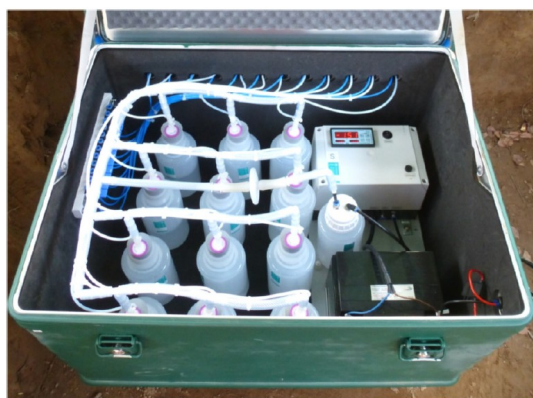
Figure 12 : dispositif de pompage et de recueil des eaux prélevées à partir des bougies/plaques poreuses (ecoTech GmbH).
