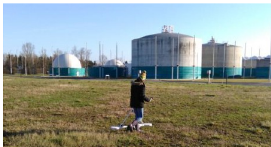
Figure 8 : mesure par conductimètre électromagnétique (Forquet et al. , 2017)
