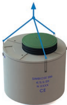
Manutention avec élingues des 3 points de levage des Stations SIMBIOSE SB 6/8/13EH
