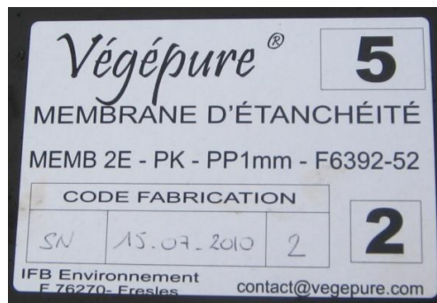
Etiquette de traçabilité de la membrane d'un filtre horizontal
