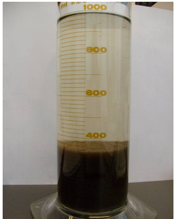
Photo 1; boue décantée après 30 minutes. Le volume est ici de 300 ml/l environ et l'eau au-dessus est claire. Voici ce à quoi un volume de boue doit ressembler.
