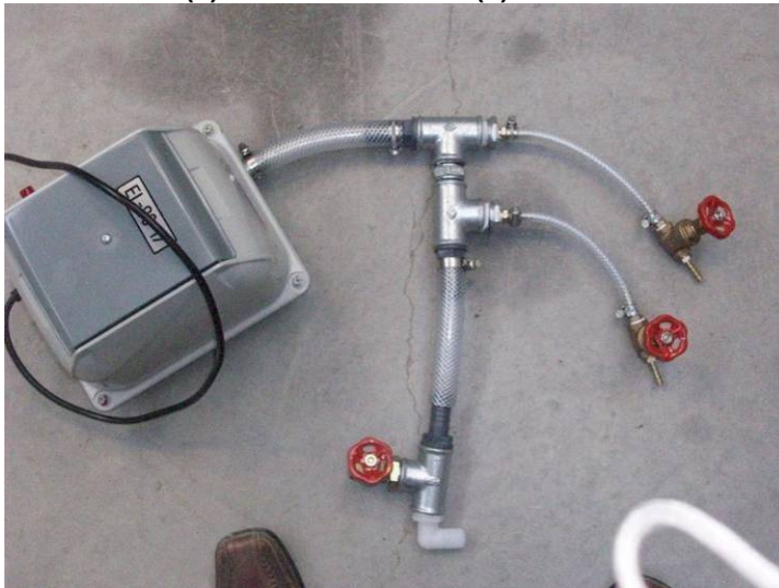
Fig. Vue d'ensemble et vannes manuelles encerclées pour ajuster les débits d'air au stabilisateur (1) et à la circulation (2).
